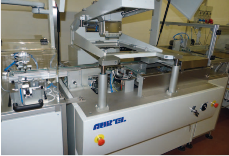
Fig. 2 - Carico automatico e area di stampa
